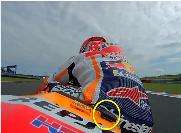
Figura 46: Antena del GPS de la Honda RCV213 de MotoGP del mismo tipo que la utilizada en este proyecto.
