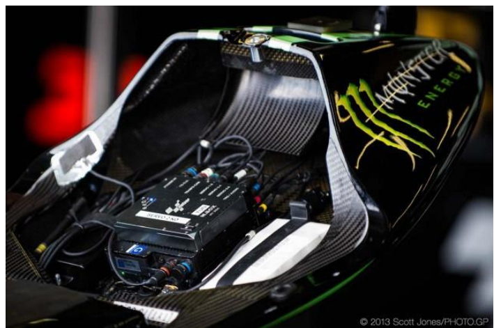
Figura 14: Parte del sistema de Adquisición de Datos de una MotoGP
