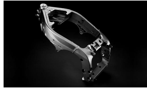
Figura 9: Chasis “deltabox” o doble viga inventado por Antonio Cobas.
