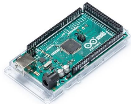
Figura 29: Arduino Mega2560 como el utilizado en el proyecto.
