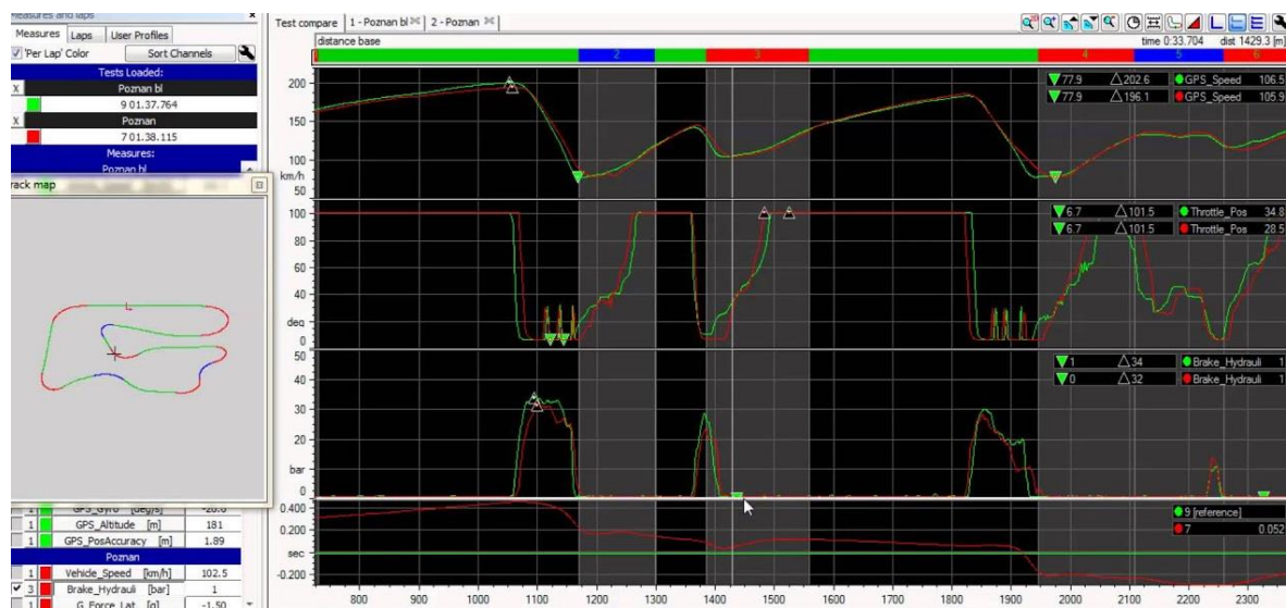
Figura 15: software de representación de los datos adquiridos de la telemetría AIM.
