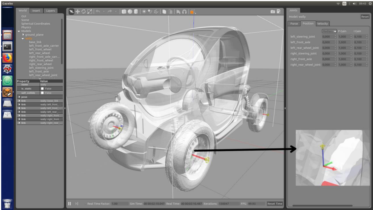
Figura 36 – Ejes de giro de la rueda directriz de mi modelo del Renault Twizy
