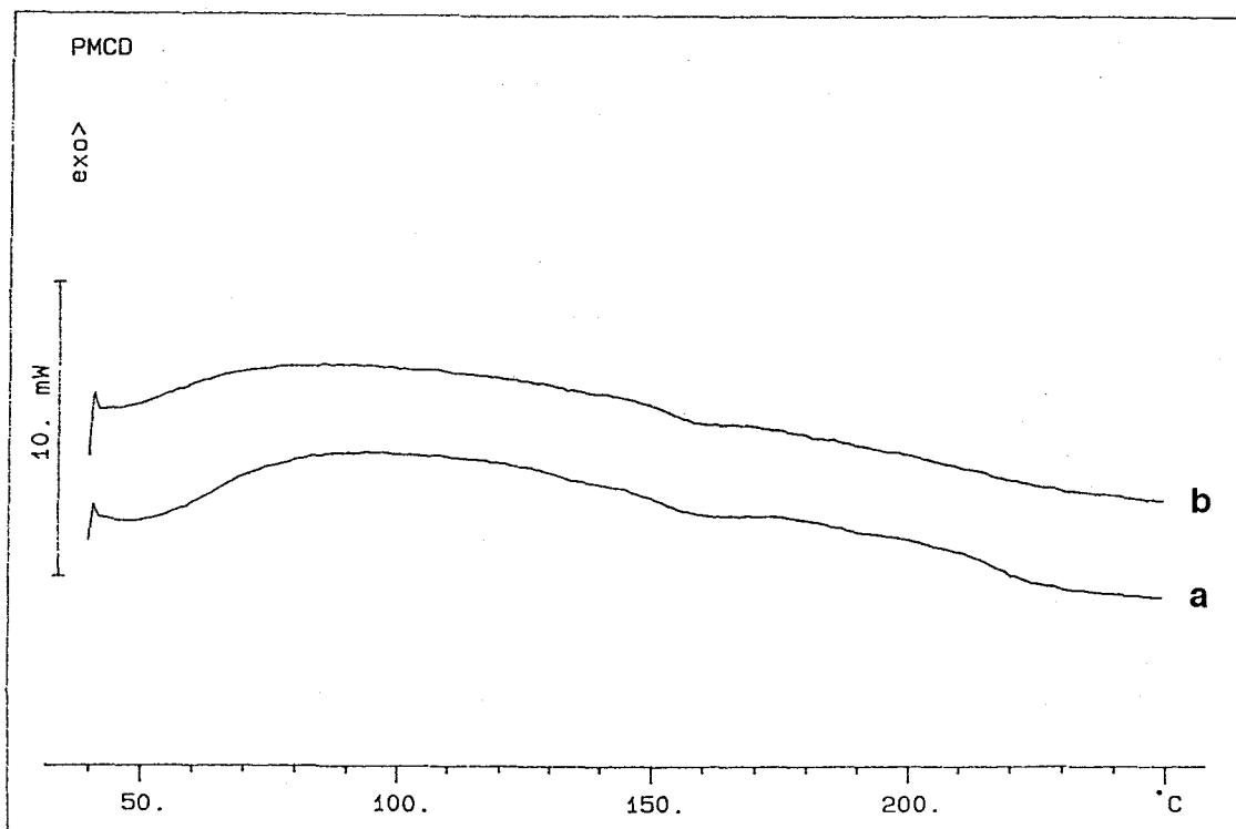
Figura 19. Termogramas por DSC correspondientes a la PMCD: (a) comercial sin precalentamiento, (b) comercial con calentamiento.
