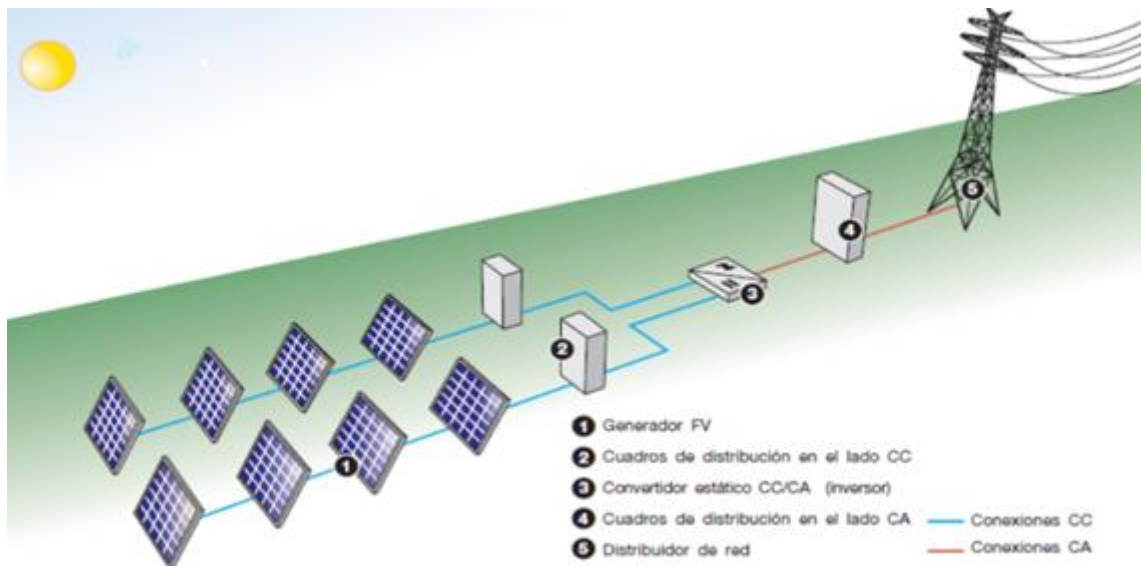
Figura 7. Esquema de una central fotovoltaica (5)
