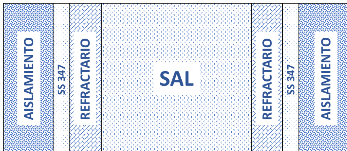
Figura 3.2. Diseño del tanque caliente para el modelo 3
