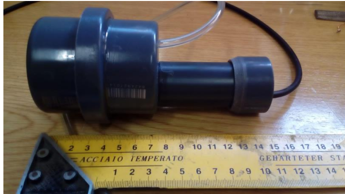
Figura 27 – Vista del soporte finalizado mientras se realiza la prueba de estanqueidad
