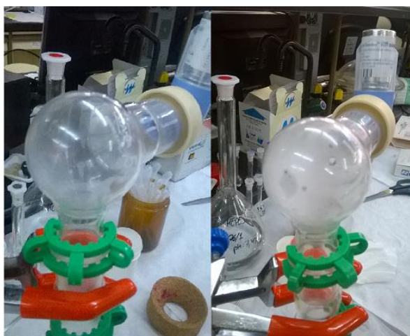
Figura 20. Fotografía del dispositivo Twin Impinger , donde se aprecia cómo se va colmatando la pieza que simula la vía orofaríngea a medida que se incrementa el número de pulverizaciones (imagen de la derecha).
