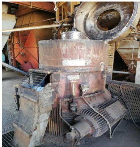
Figura 8: Granuladora de orujo
