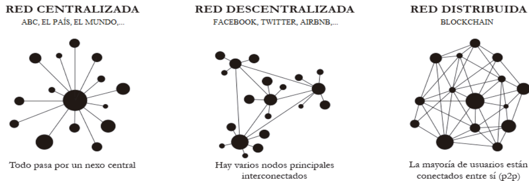
Figura 1: Tipos de redes: centralizada, descentralizada y distribuida
