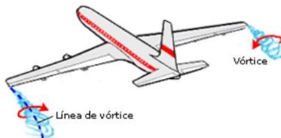
Figura 2. Vórtices de las estelas de un avión
