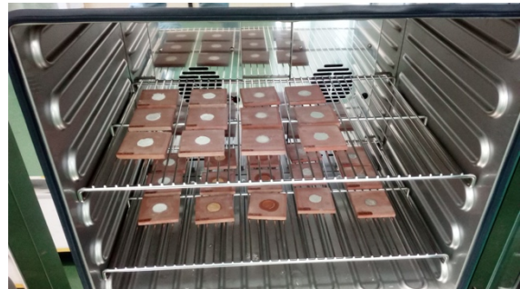
Figura 3. Grupo de muestras de ensayo en el interior de la incubadora Memmert® IPP 110
