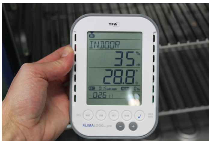
Figura 6. Primera comprobación de condiciones de HR para la realización de la prueba
