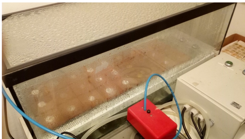
Figura 4. Grupo de muestras de ensayo durante el desarrollo de la fase de humectación de la prueba de HR
