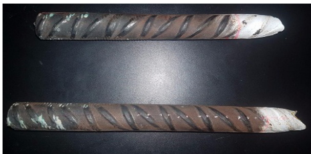
Figura 4. Barra ya ensayada hasta rotura B500SD-7 preparada para escaneado.
