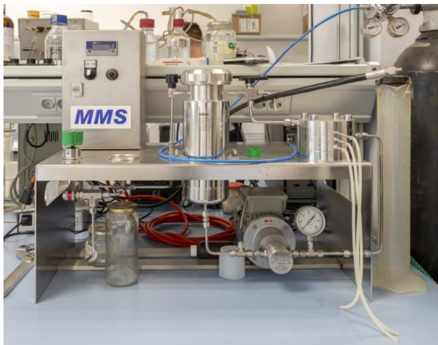
Figura M&M.4 Equipo de osmosis inversa (OI).
