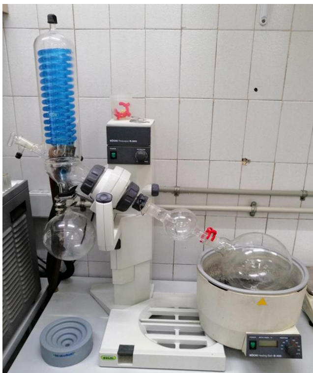
Figura M&M.3 Rotavapor (Büchi, Suiza).
