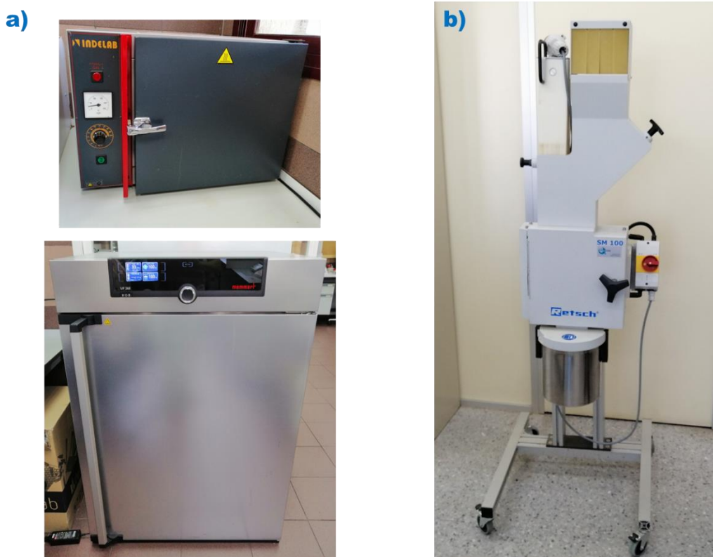
Figura M&M.2 a) Estufa de secado estático y con flujo de aire caliente, b) Molino.
