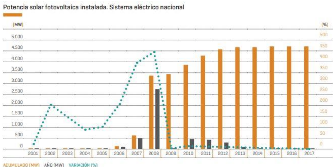
Figura 1.1. Evolución de la potencia solar fotovoltaica instalada en España.
