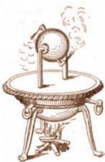
Figura 1-1 Motor a vapor de Herón [4]
