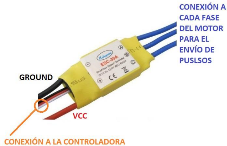
Figura 2-26 Esquema de los terminales de un variador
