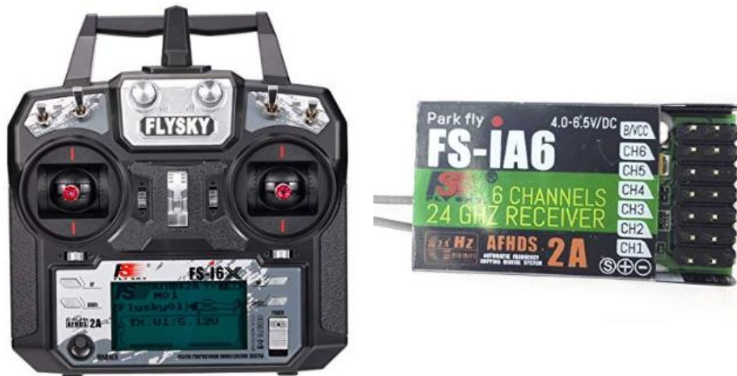
Figura 2-10 Emisora Flysky Fs i6 y Receptor asociado
