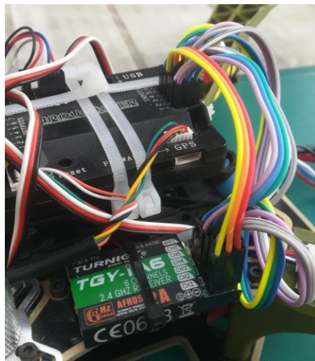
Figura 2-31 Receptora instalada en el drone con su correspondiente conexión a la controladora
