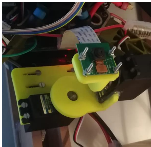
Figura 4-13 Instalación de la nueva plataforma para la cámara
