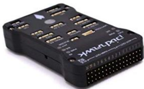
Figura 2-13 Pixhawk de la empresa Ardupilot
