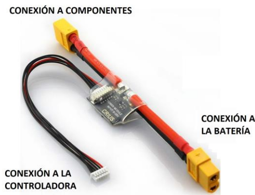
Figura 2-24 Conexiones del módulo de potencia
