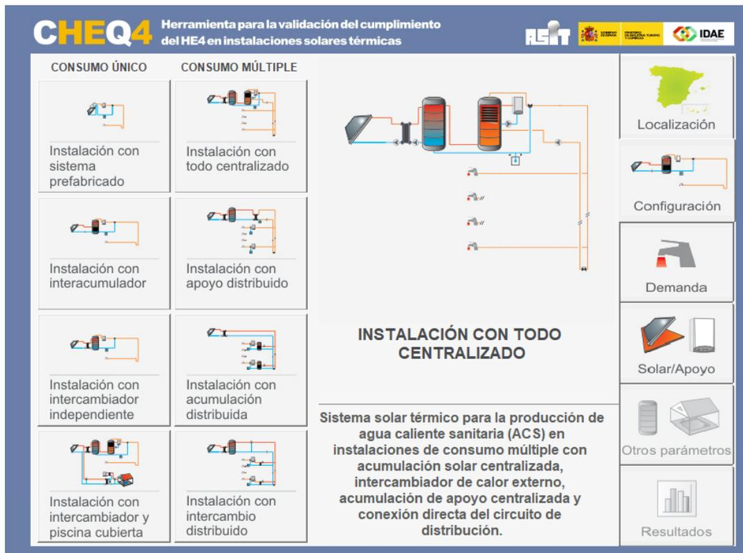
Figura 1- 4: CHEQ4; Pestaña de Configuración
