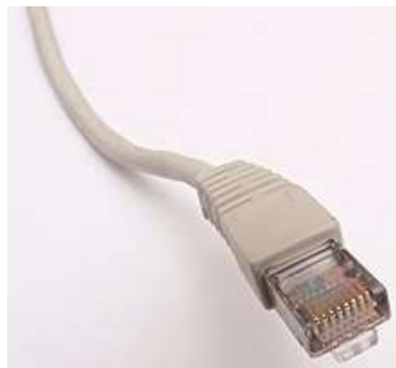
Figura 3.6 Cable de red RJ45.
