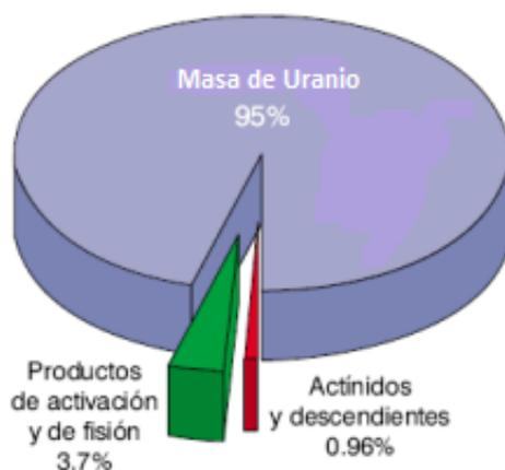
Figura 4.12. Composición de una pastilla de combustible gastado con un quemado de 40000 MW/tU [79]
