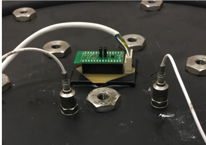
Figura 2-4. Distribución de los acelerómetros fijados en la superficie vibratoria.
