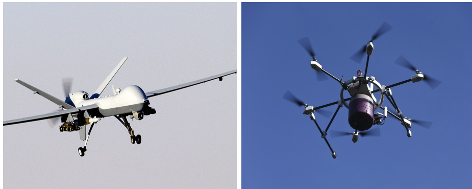
(a) General Atomics MQ-9 Reaper. UAV esta- (b) UAV de transporte desarrollado por Con- dounidense militar diseñado para misiones de vi- nect Robotics. gilancia a grandes altitudes.
