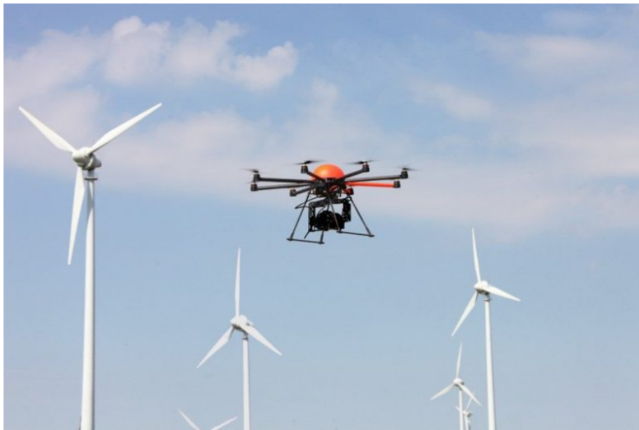
(c) UAV realizando operaciones de inspección y mantenimiento en las turbinas eólicas.
