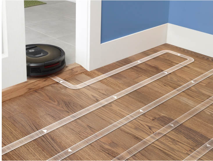
Figura 1.11: Roomba iRobot realizando limpieza de un piso, siguiendo una ruta.
