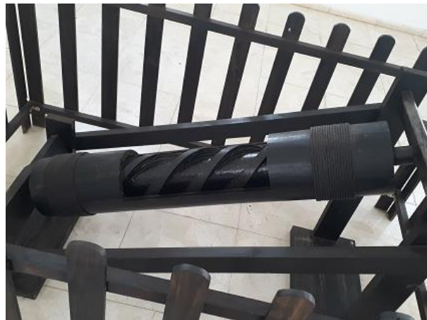
Figura 34: Reproducción de tornillo hidráulico.
