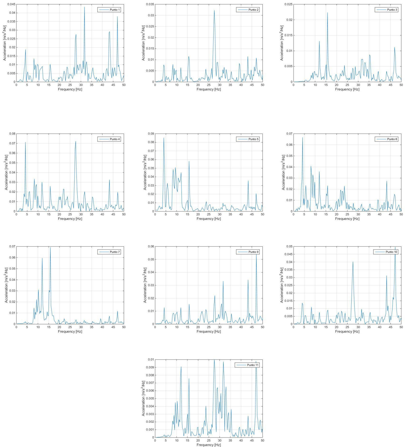
Figura 8-7. Aceleraciones en el dominio de la frecuencia para el evento 7 en los diferentes puntos de medida indicados en la Figura 5-2. Puente Arroyo Bracea
