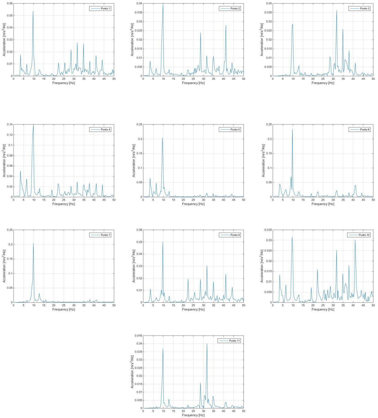
Figura 8-8. Aceleraciones en el dominio de la frecuencia para el evento 8 en los diferentes puntos de medida indicados en la Figura 5-2. Puente Arroyo Bracea
