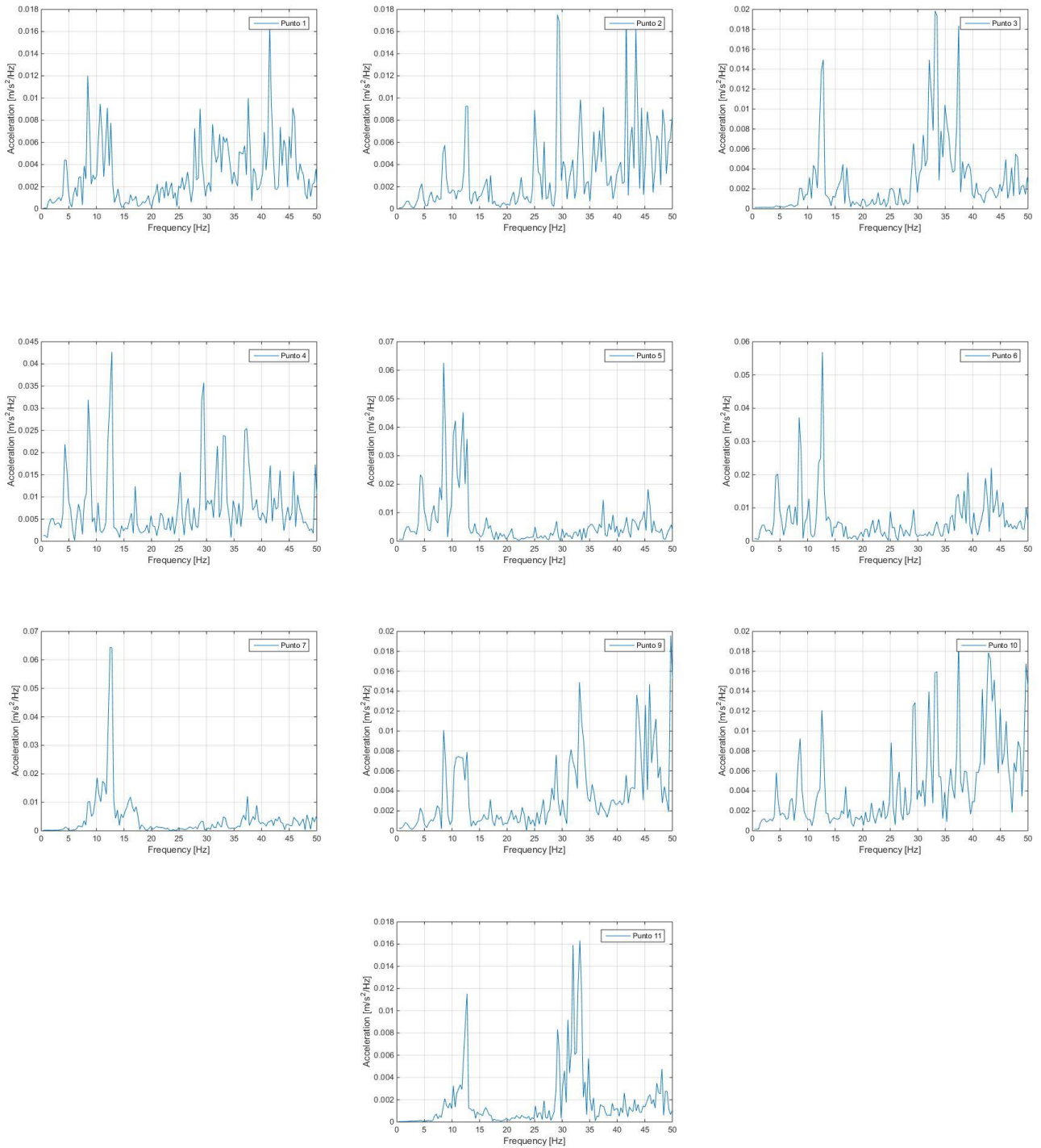
Figura 8-10. Aceleraciones en el dominio de la frecuencia para el evento 10 en los diferentes puntos de medida indicados en la Figura 5-2. Puente Arroyo Bracea
