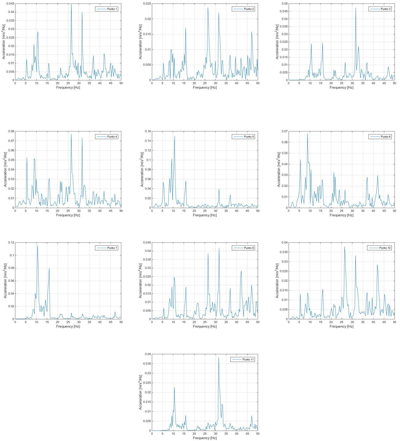
Figura 8-4. Aceleraciones en el dominio de la frecuencia para el evento 4 en los diferentes puntos de medida indicados en la Figura 5-2. Puente Arroyo Bracea
