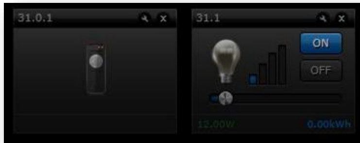
Figura 25. Dimmer en la aplicación de Fibaro
