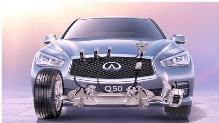
Figura 5: Infinity Q50 con sistema steer-by-wire y columna de dirección con embrague
