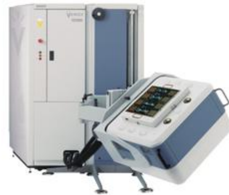
Figura 4.2.: Equipo de test Agilent 93000.
