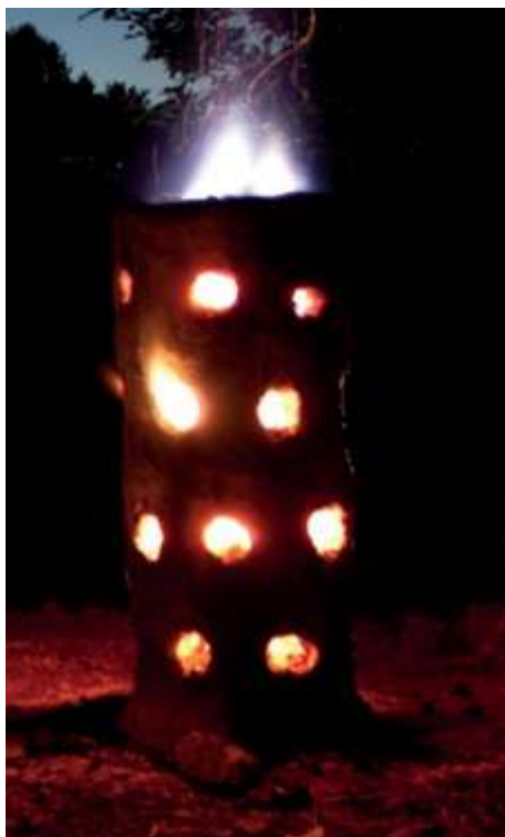
Figura 2.37. “wayra” experimental. (Téreygeol y Cruz, 2014).
