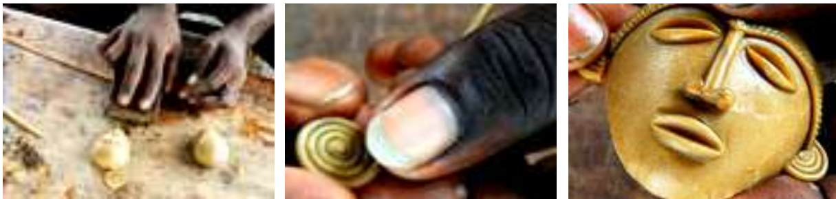
Figura 4.57. Formación de hilos de cera a partir del enrollado con madera. Ashanti. (Ventura, 2010).
