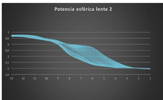
**Figura 17:** Vista lateral. Evolución de la potencia esférica en lente 2.
