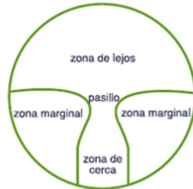
*Figura 3: Lente progresiva. Diferenciación de las distintas zonas de visión, pasillo de progresión y zonas marginales.*
