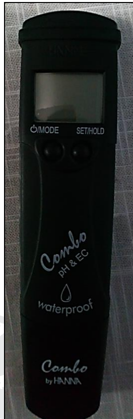
Figura 42. Multiparámetro pH/conductividad/TDS (intervalo alto)
