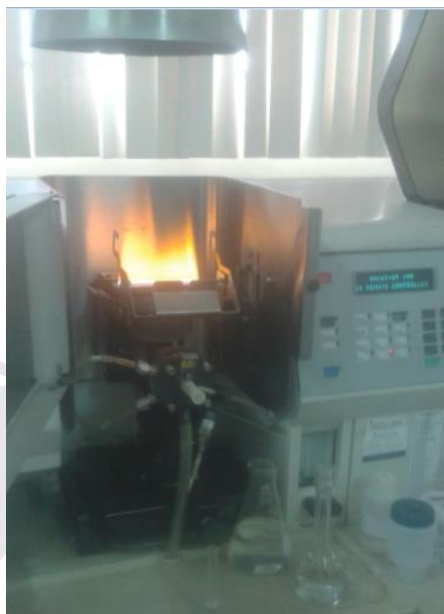
Figura 41. Equipo de absorción atómica “ PERKIN ELMER ” asociado a llama directa
