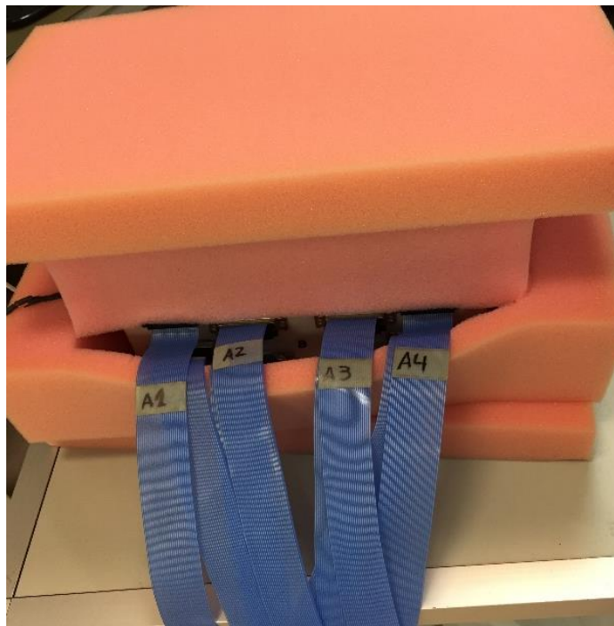
Figura 25: Vista lateral del chasis embebido en el material aislante
