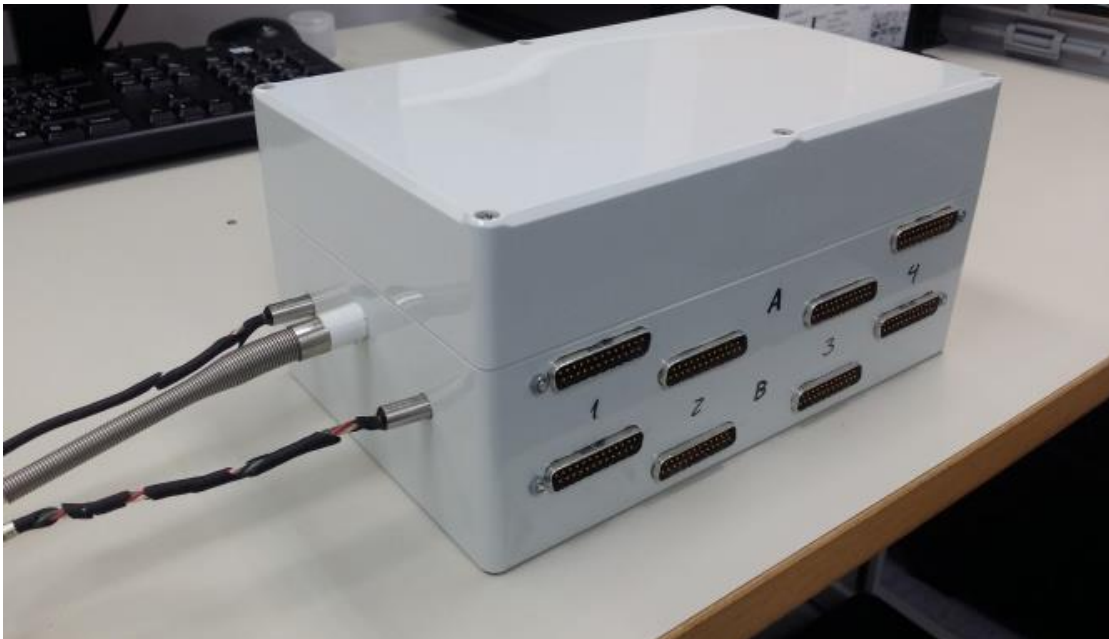
Figura 3: Sistema de soporte y conexión de los termistores con las tres sondas incorporadas (a la izquierda de la imagen)
