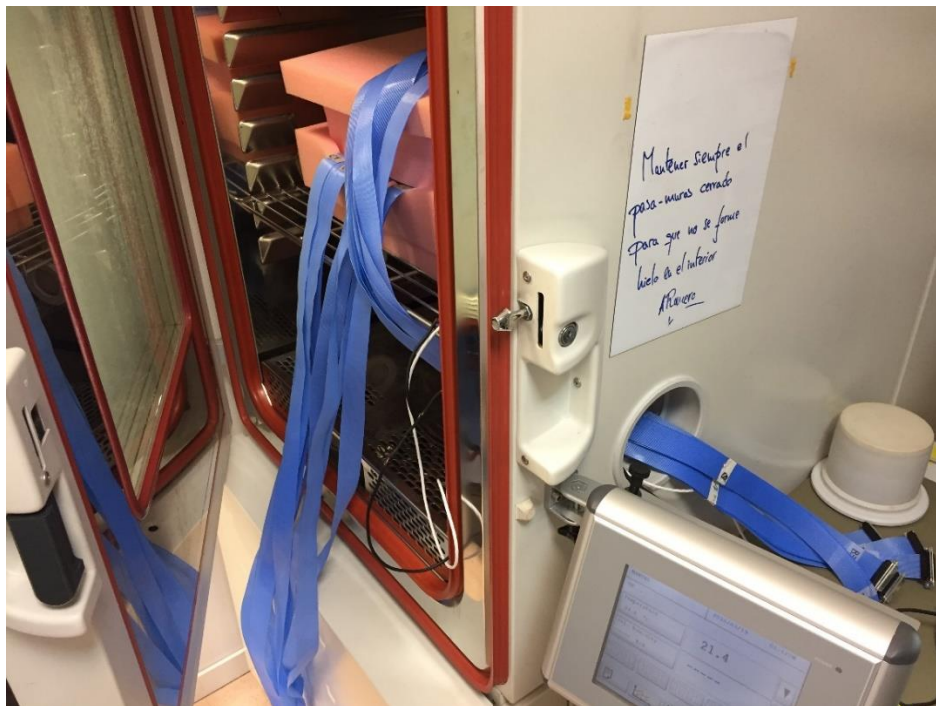
Figura 28: Cintas de cable plano de la parte posterior pasando por el pasamuros
