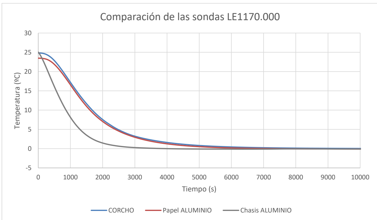
Figura 58: Gráfica comparativa de las lecturas que ha efectuado la sonda LE1170.000 en los sistemas propuestos
