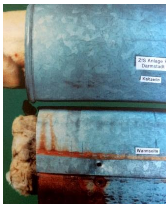
Figura 6.10. Recubrimiento de acero galvanizado de una posición protegida (arriba) con sólo ligera corrosión, y de una posición no protegida (abajo) con efectos corrosivos mayores.
