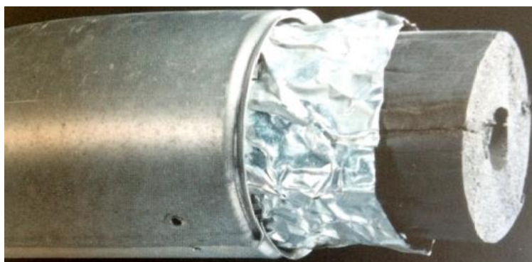
Figura 6.11. Recubrimiento de aluminio de un material aislante de poro cerrado.
