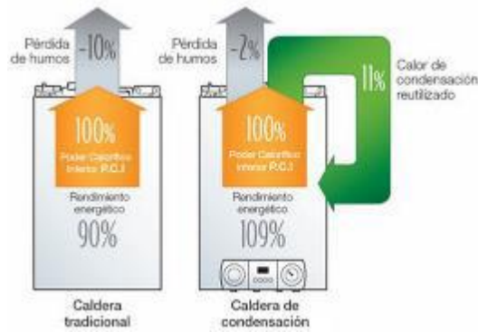
Figura 3.2. Calderas de condensación.
