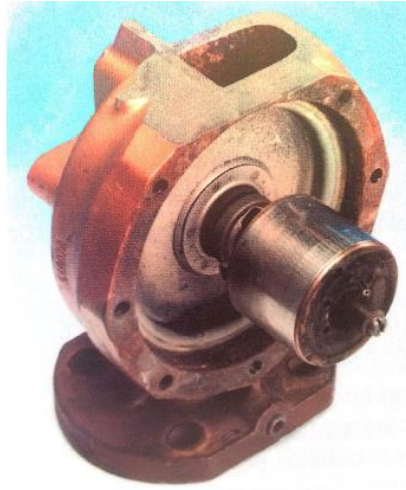
Figura 6.15. Carcasa del motor de una bomba carente de toda sedimentación.
