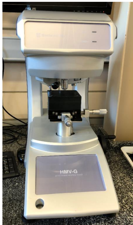
Figura 3.20 Microdurómetro utilizado para ensayo de dureza Vickers
