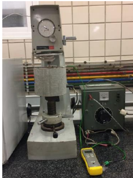
Figura 3.21 Durómetro Brinell con horno para medidas de dureza en caliente
