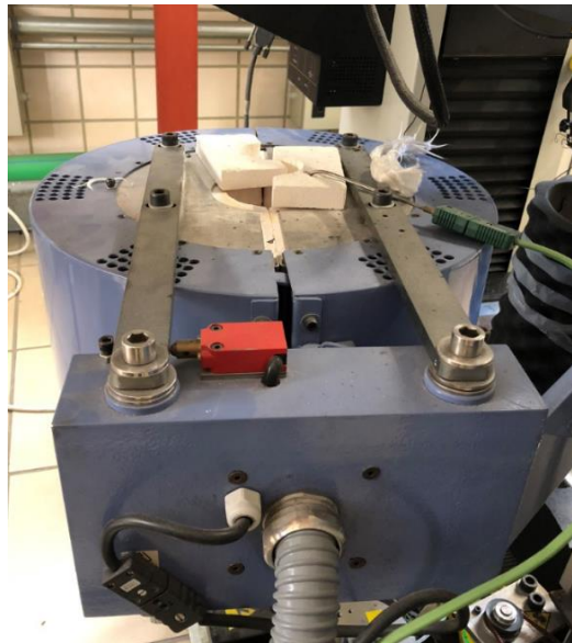
Figura 3.17 Horno utilizado para ensayos de tracción en caliente
