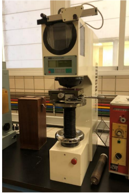
Figura 3.13 Durómetro universal utilizado para la medición de las marcas de las probetas
