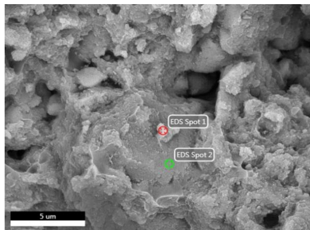
Figura 4.20 Puntos escogidos para análisis por EDX de la composición de la superficie de fractura de la muestra F10 P HT AT400-100
