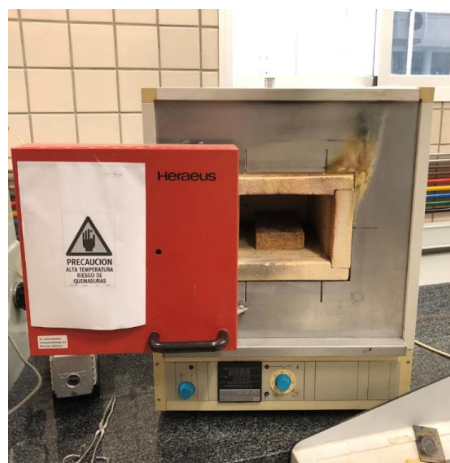
Figura 3.14 Horno utilizado para la realización de tratamientos térmicos
