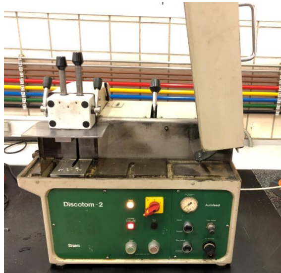
Figura 3.22 Máquina de corte con sierra de disco empleada en la preparación de muestras
