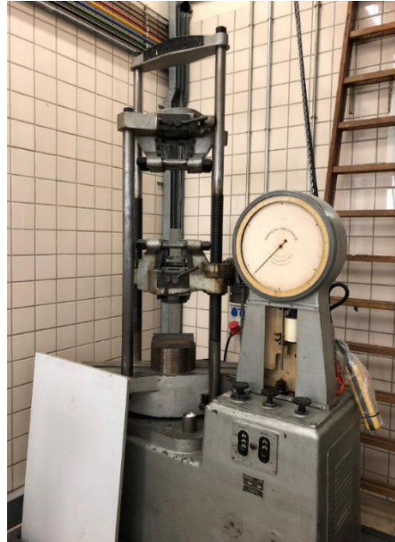
Figura 3.8 Prensa de control manual para extracción de los compactos de la matriz
