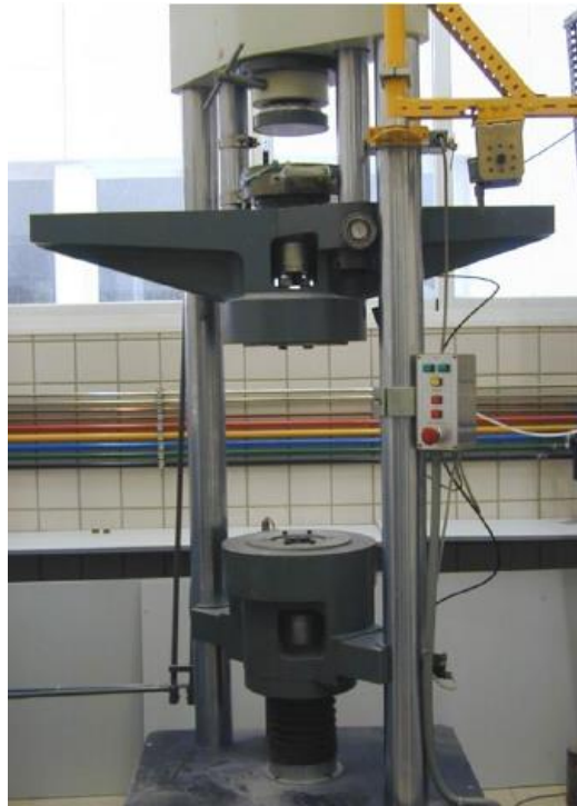
Figura 3.7 Máquina universal de ensayos SUZPECAR MUE – 60 utilizada en el prensado
