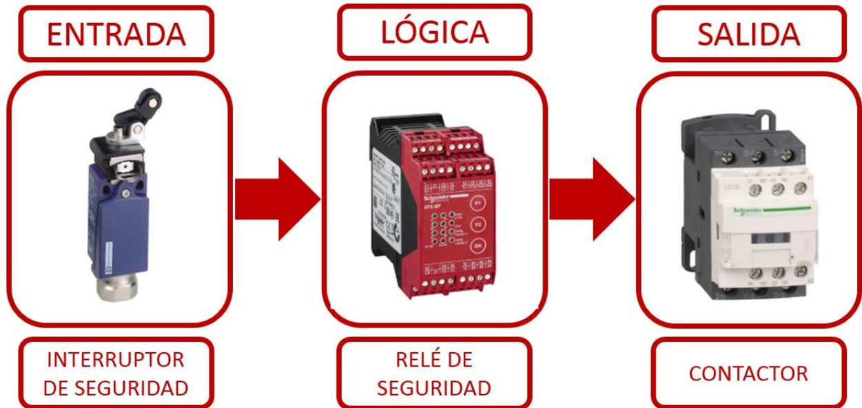
Figura 5-33. Función de seguridad para los interruptores de seguridad.
