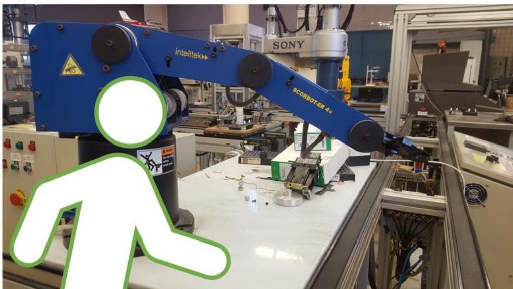
Figura 5-12. Riesgo de golpes en el área de trabajo del brazo robótico SCORBOT.
