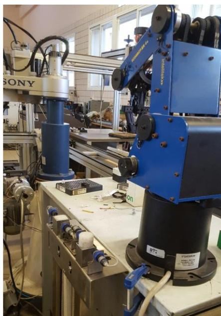
Figura 2-4. Robot SCORBOT-ER 4u con su dispensador de piezas para pallets.
