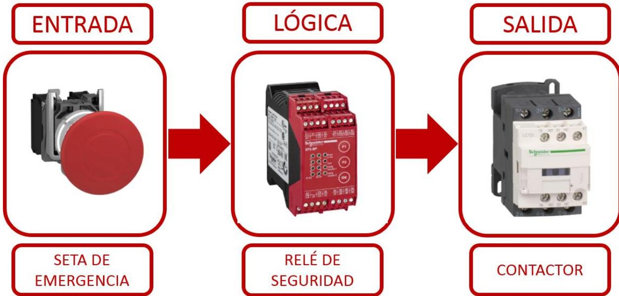
Figura 5-35. Función de seguridad para las setas de emergencia.
