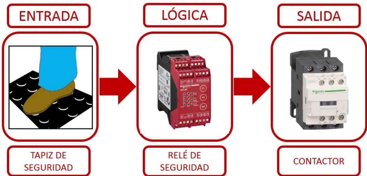
Figura 5-32. Función de seguridad para los tapices de seguridad.
