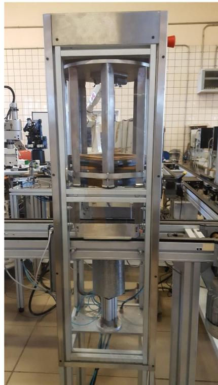
Figura 2-7. Alimentador de bandejas de la célula de fabricación flexible.
