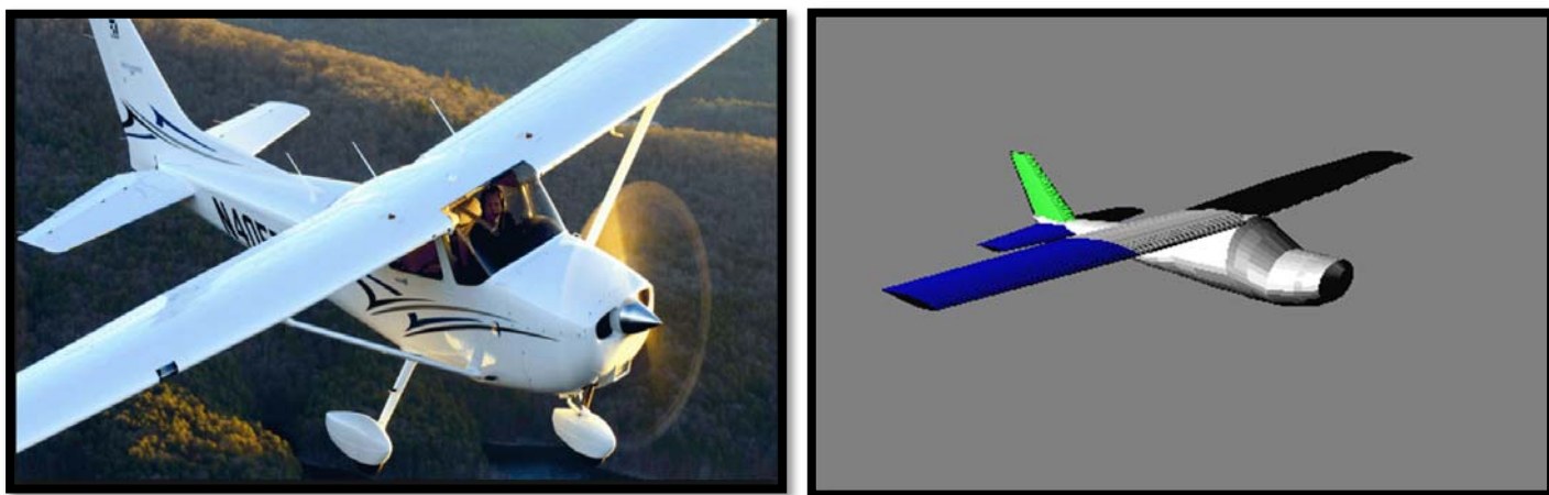
Figura 3. A la izquierda una Cessna 172 real en vuelo, a la derecha el modelo creado por la herramienta DATCOM
