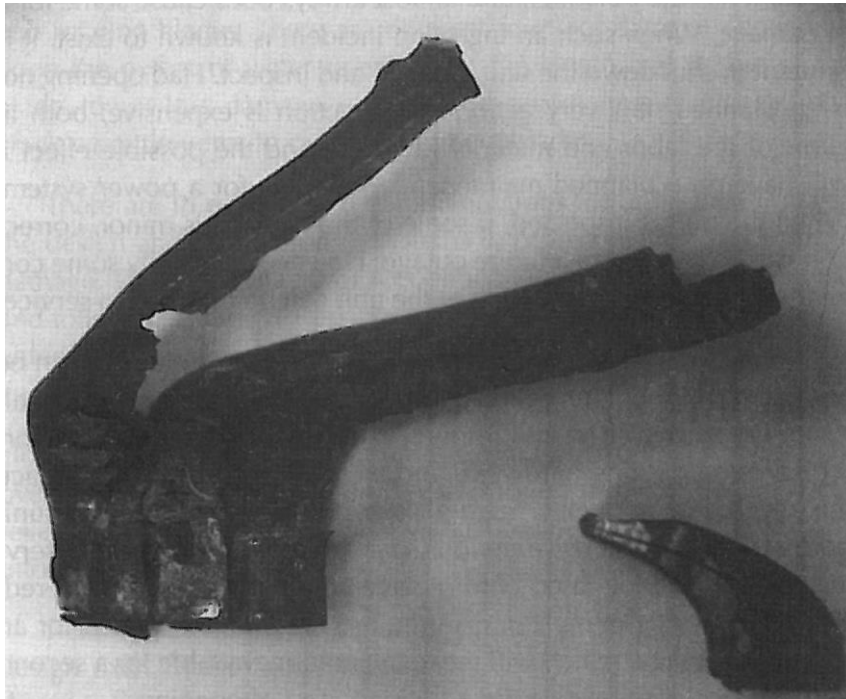
Figura 4.41 Alabes torcidos y desprendidos causados por la ingesta
