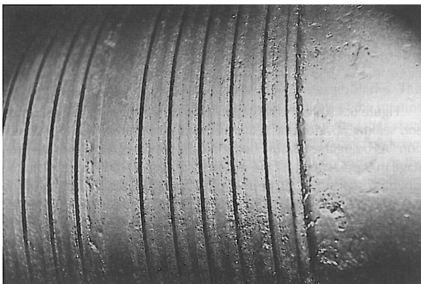
Figura 5.3 Corrosion por picadura en los sellos del final del eje de una turbina pequeña industrial
