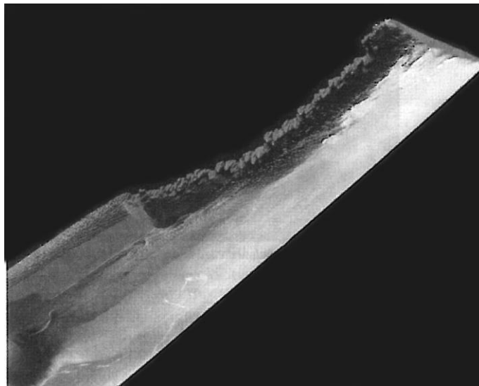
Figura 4.14 Erosión sobre el material base del álabe después de la pérdida de la capa de protección
