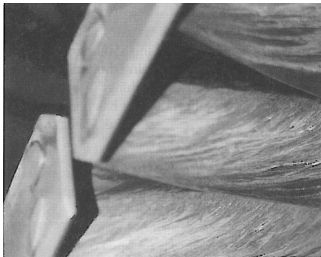
Figura 4.34 Marcas del flujo en los álabes de la corona del rotor
