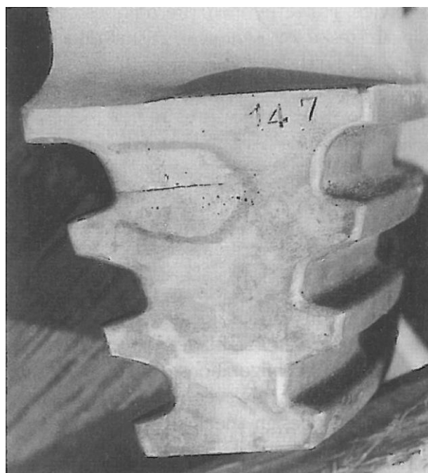
Figura 5.23 Apariencia de la grieta en la raíz del álabe
