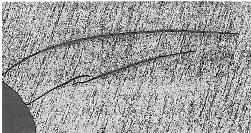
Figura 5.22 Grieta transgranular en la raíz del álabe
