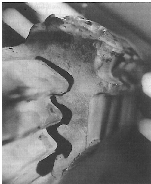
Figura 3.2 Raíz de álabe del escalonamiento de control que ha sufrido daño por fluencia
