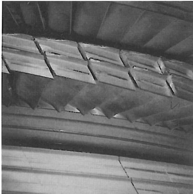
Figura 2.32 Deformación tangencial del álabe debido al roce intenso
