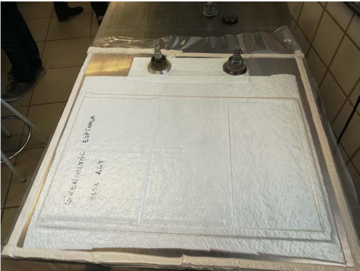
Figura 3-20. Vacío de las placas.
