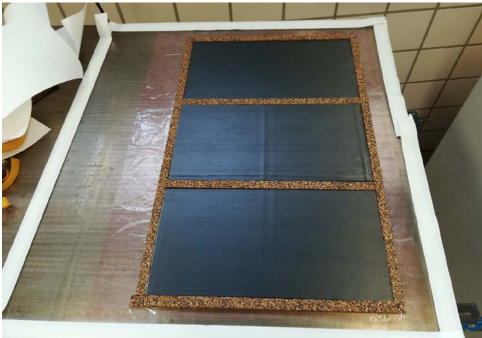
Figura 3-16. Retirada del papel protector de la capa superior.
