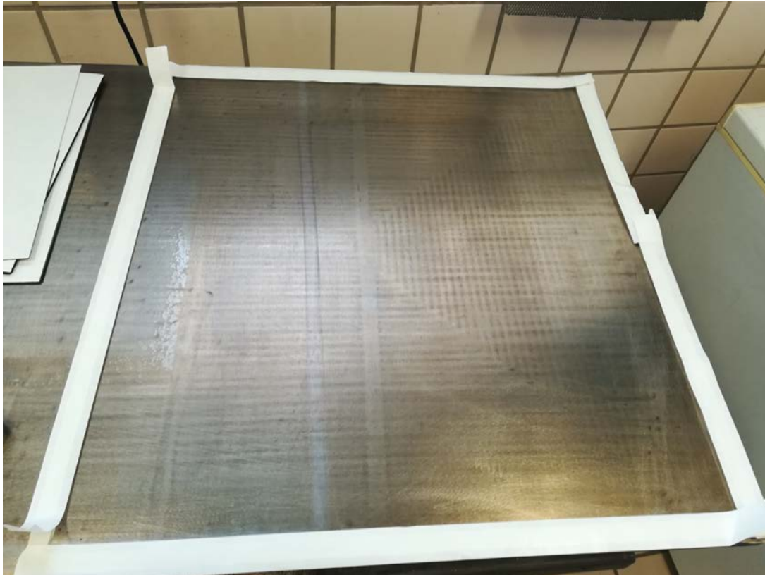
Figura 3-14. Colocación de la cinta de cromato.
