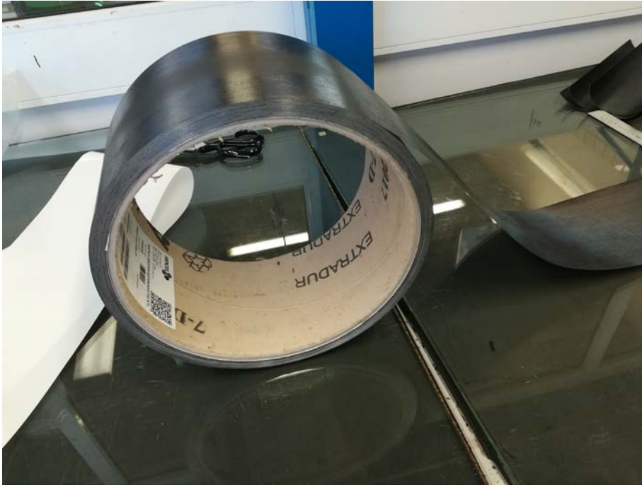
Figura 3-3. Rollo de 150 mm de fibra de carbono AS4 8552.
