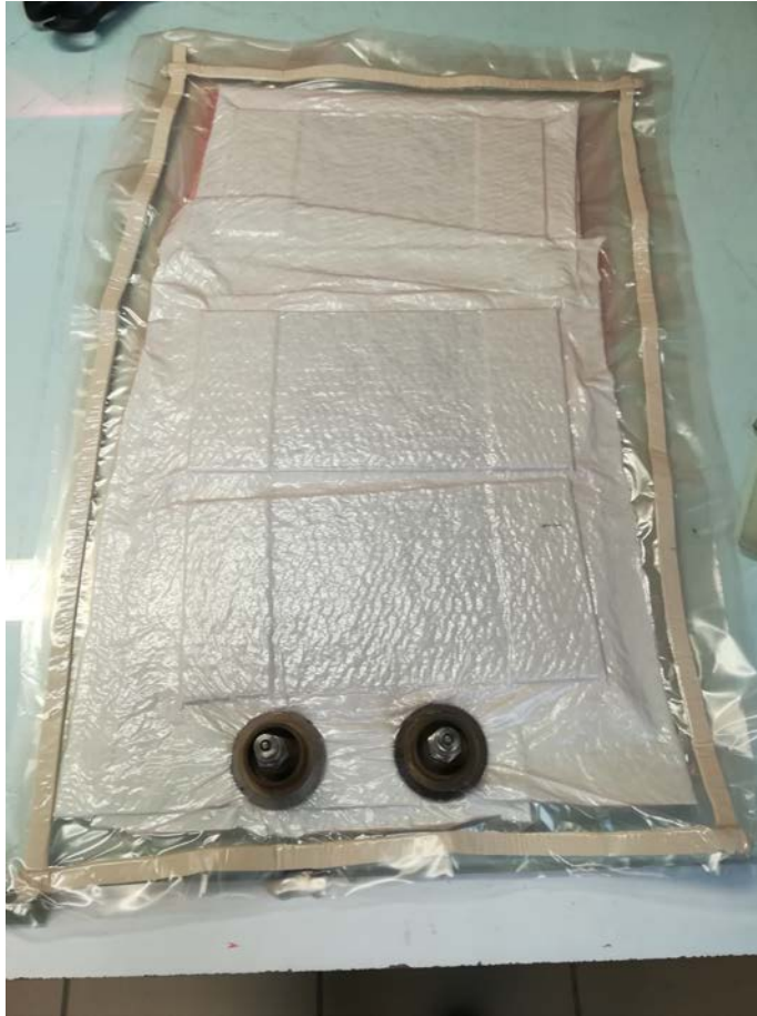
Figura 3-37. Bolsa de vacío para la colocación de los tacos.
