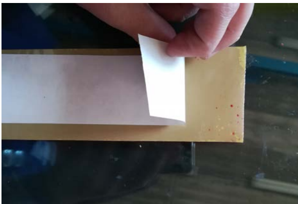
Figura 3-35. Retirada de la doble capa de papel protector del adhesivo.
