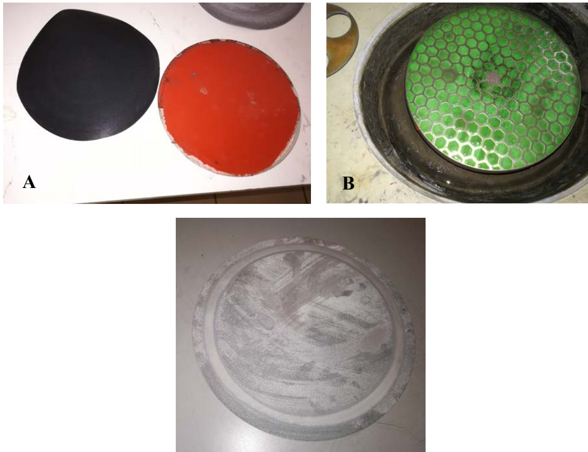
Figura 4-3. A) Disco con adhesivo y disco Si#320. B) MD Largo. C) MD Nap T.
