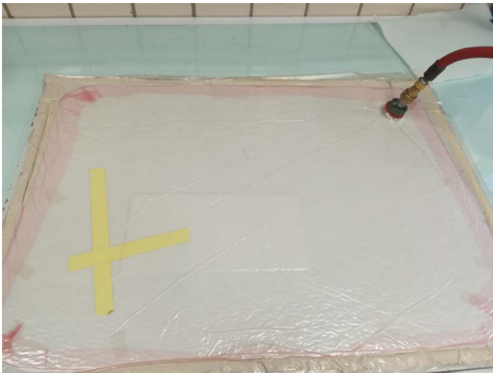
Figura 3-11. Precompactación en una bolsa de vacío.
