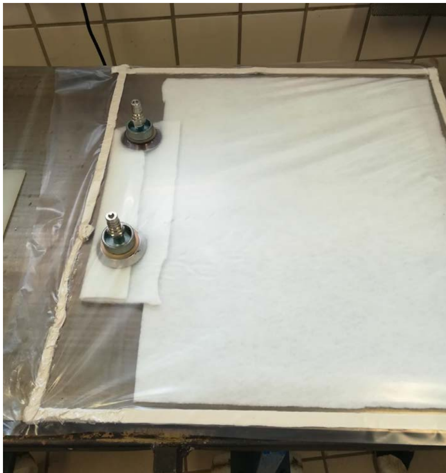
Figura 3-19. Acabado de la bolsa de vacío.
