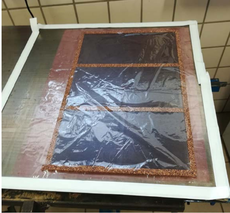
Figura 3-17. Colocación de la segunda capa antiadherente.
