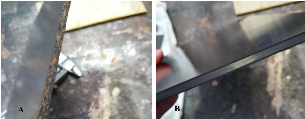
Figura 3-28. Canto de las placas antes (A) y después (B) del resanado.
