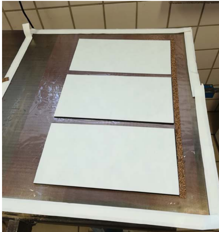
Figura 3-15. Colocación del plástico antiadherente y del corcho.
