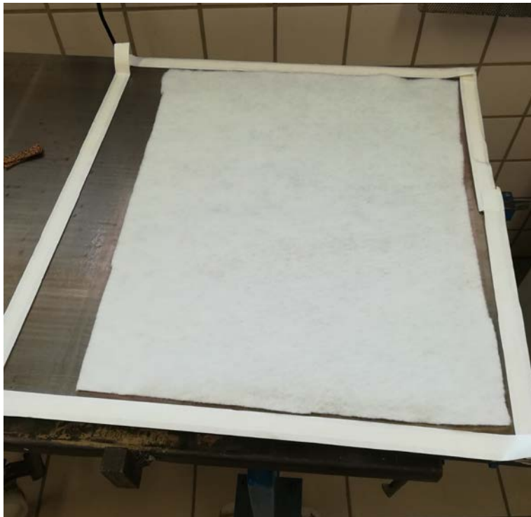
Figura 3-18. Colocación del tejido aireador.
