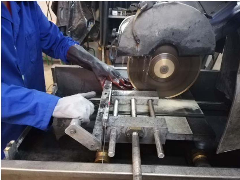
Figura 3-27. Máquina para el resanado. Prácticas de Materiales Compuestos , Jesús Justo et al. (2014).
