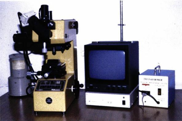
▲ Equipo medidor de dureza
