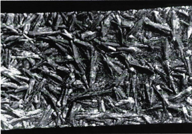
Figura 4.11: Alambre de ortodoncia sin tratar (imagen mejorada mediante tratamiento informático, proveniente de microscopía óptica,  $\times 200$ ).
