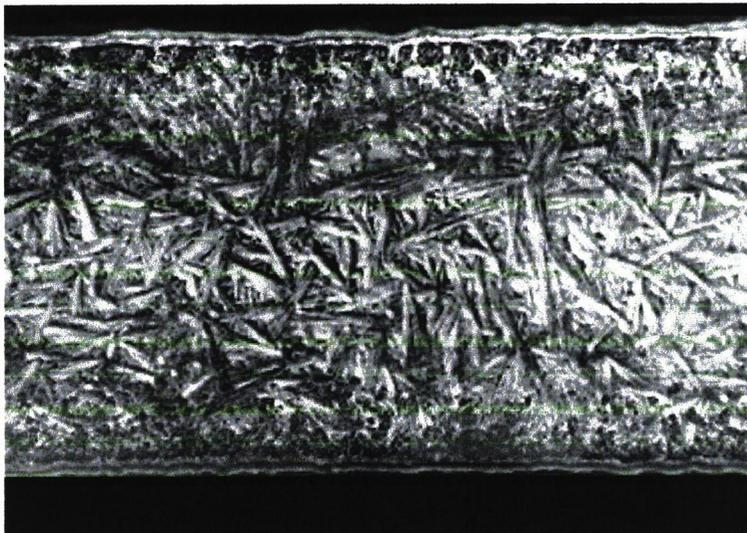
Figura 4.13: Alambre de ortodoncia tratado 20' a 1000°C y dejado enfriar en horno (imagen mejorada mediante tratamiento informático, proveniente de microscopía óptica,  $\times 200$ ).
