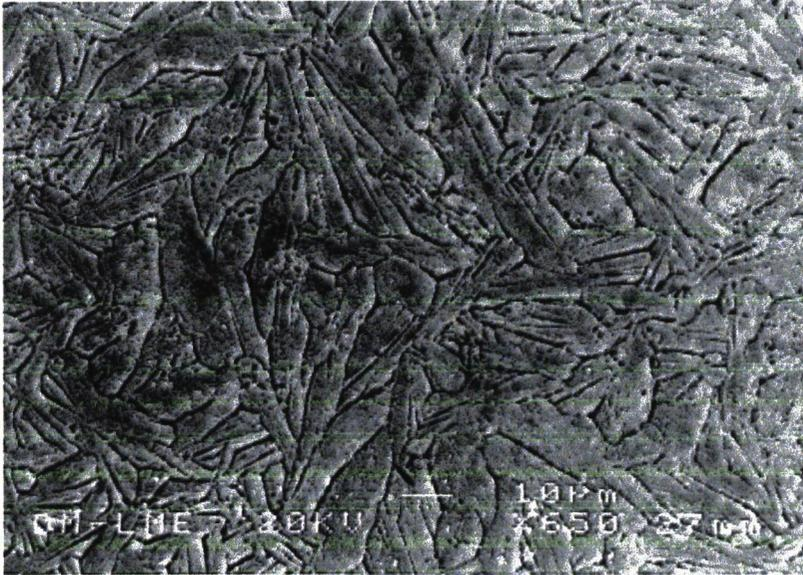
Figura 4.12: Material tratado 20' a 900°C y dejado enfriar en horno (imagen mejorada mediante tratamiento informático, proveniente de microscopía electrónica,  $\times 650$ ).
