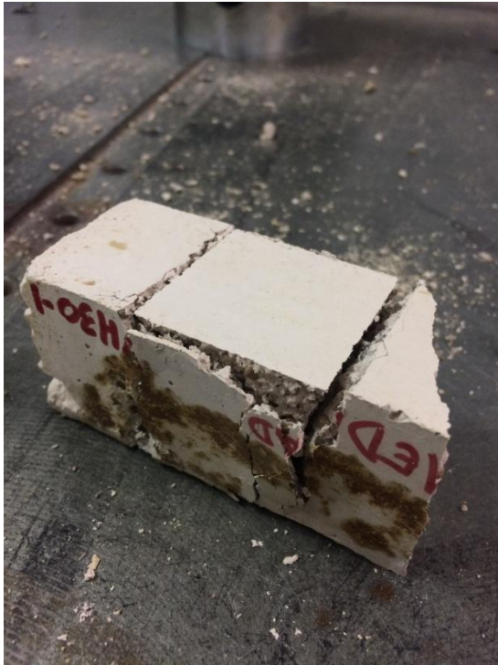
Fig. 30. Rotura de una probeta tras el ensayo a compresión
