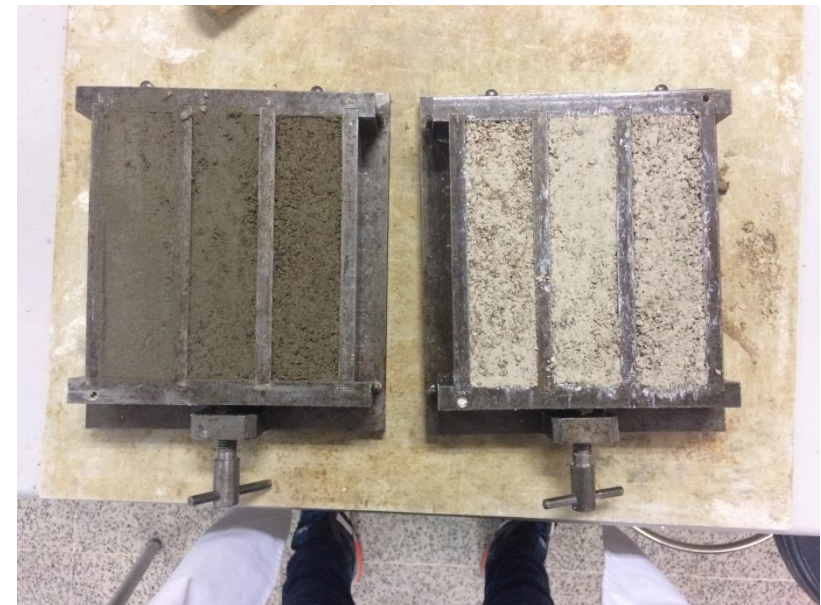
Fig. 14. Probetas e cemento y cal en sus encofrados
