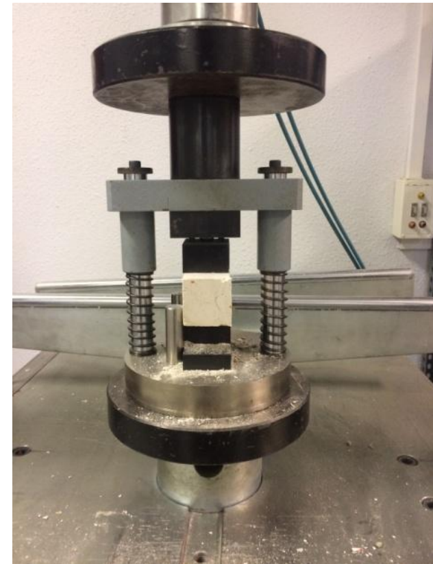
Fig. 4. Ensayo de resistencia a compresión. ETSAS
