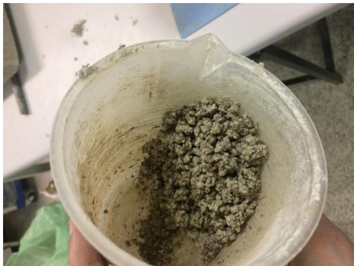
Fig. 21. Falta de humedad en la mezcla C + H
