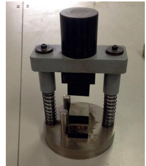
Fig. 29. Base para aplicación de la carga a compresión
