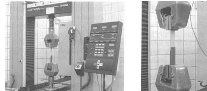
Fig. 4 - Ensayo de las muestras mediante cortadura a tracción.
