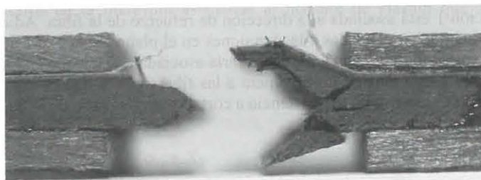
Fig. 1. Fallo de un laminado unidireccional bajo compresión pura perpendicular a las fibras.
