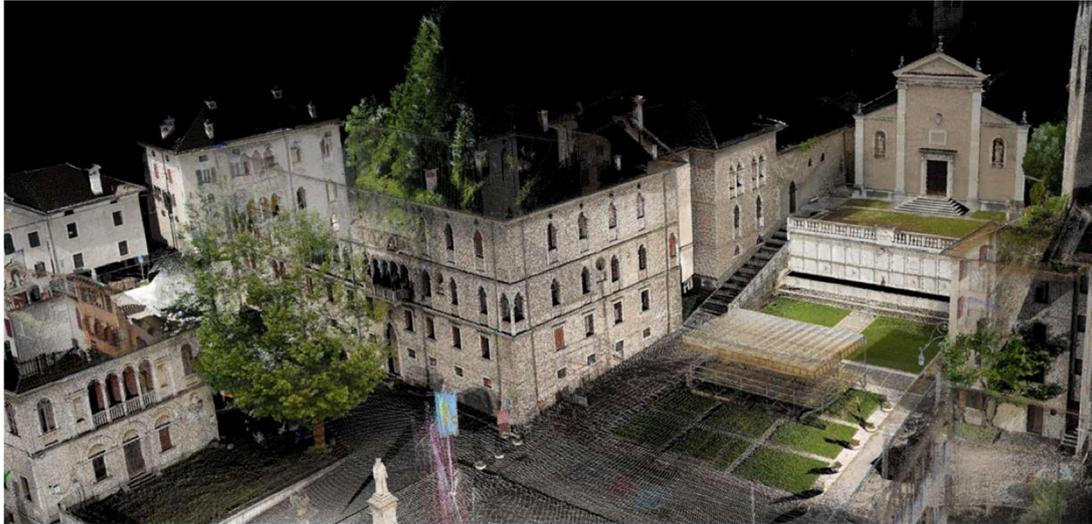
Imagen 6: Resultado de la toma con escáner 3D de la Fortezza da basso de Florencia. (MicroGeo , s.f.)
