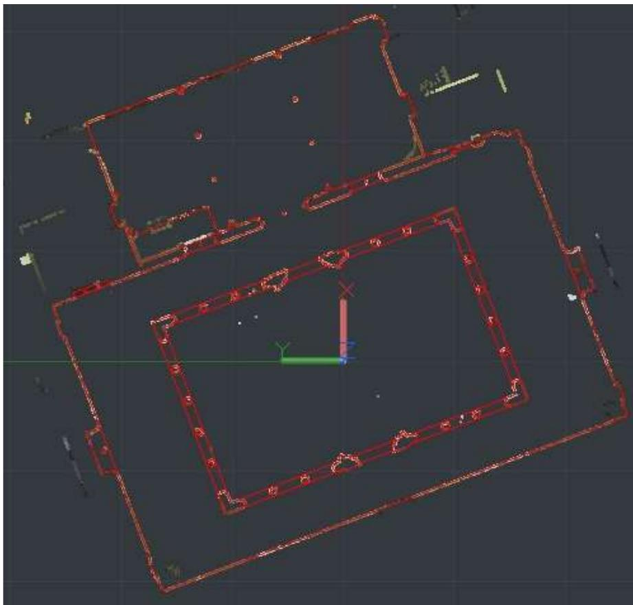
**Imagen 60: Planta del área levantada a través de la rebanada a la nube de puntos.**
