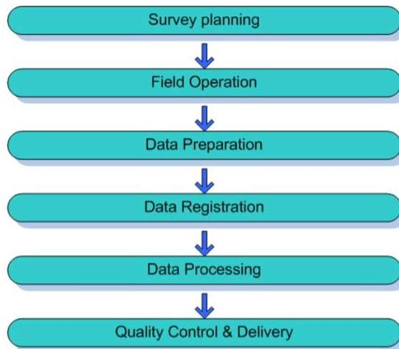
**Imagen 1: Un posible flujo de trabajo con escáner láser terrestre. (Lerma García & Biosca Tarongers, 2008)**
