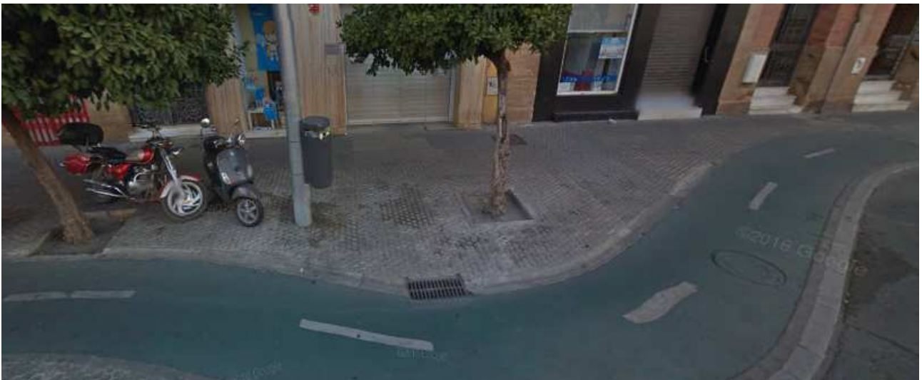
Imagen 8. Calle Demetrio de los Ríos. Calle Demetrio de los Ríos en su confluencia con la Avenida Menéndez Pelayo. El carril-bici transcurría previamente entre el arbolado y la fachada, sin permitir adecuadamente el paso de peatones y propiciando conflictos entre viandantes y ciclistas. El nuevo trazado gana superficie a la calzada y destina el espacio que antes ocupaba el carril-bici al paso peatonal. El carril-bici se estrecha y mediante una curva se sitúa en el lado externo del arbolado. Foto recuperada de Google Maps.
