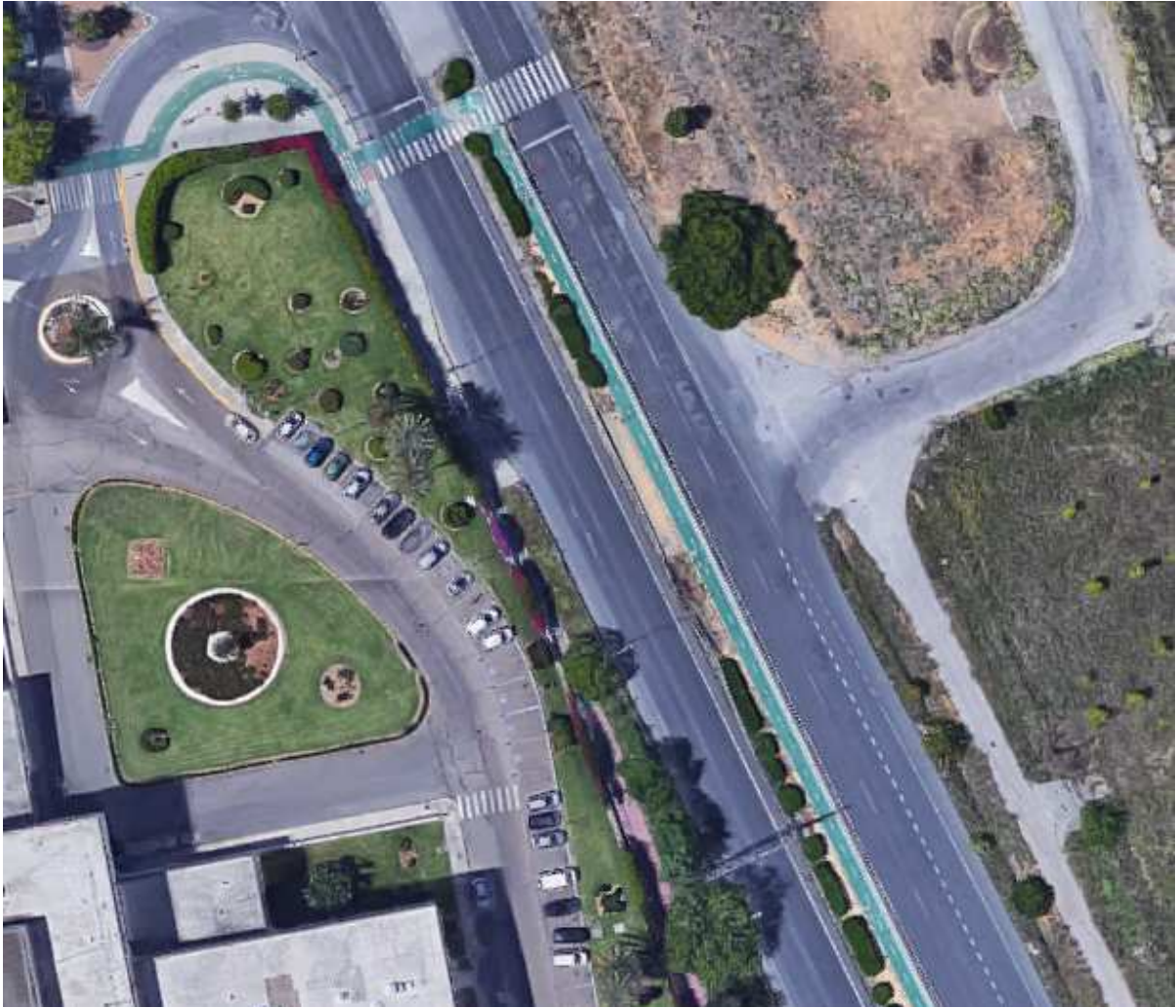
Imagen 5. Avenida de Jerez. Vista aérea de la Avenida de Jerez a la entrada del puente sobre la autopista A-4/SE-30. Se observa que el trazado del carril-bici abandona el acerado para situarse en la mediana de la vía. Foto recuperada de Google Maps.
