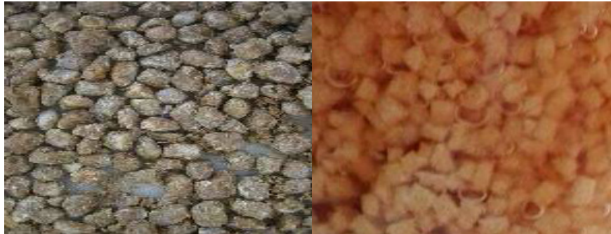
Figura 13. Arena silícea y espuma de poliuretano utilizada como soporte.
