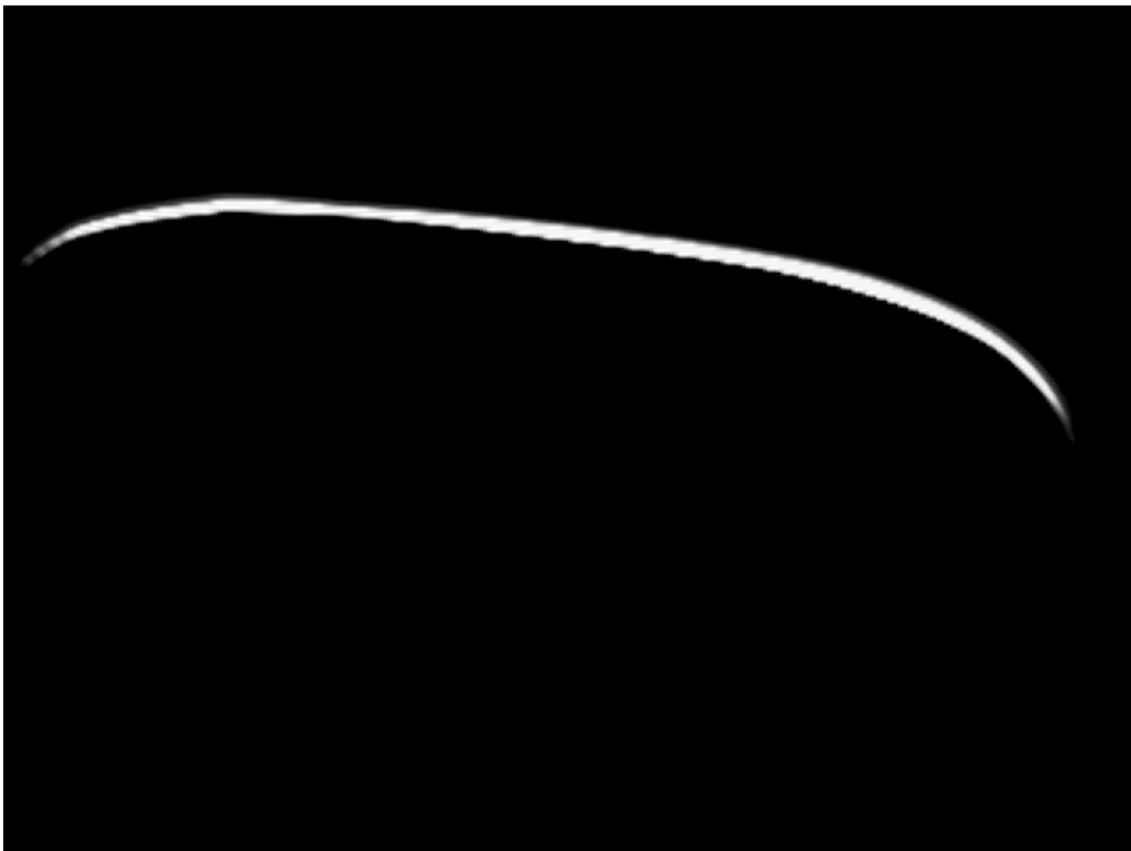
Figura 2.4: Fotografía del perfil del carril iluminado con el tiempo de exposición ligeramente elevado (perfil difuminado por movimiento).
