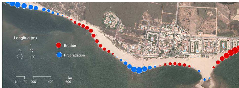
Figura 4. Representación de las tasas de erosión 1979-2009 en Ayamonte (Huelva). Fuente: Elaboración propia.
