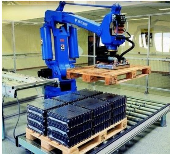
Figura 2. Ejemplo de robot manipulador: robot manipulador de pallets vacíos. [4]
