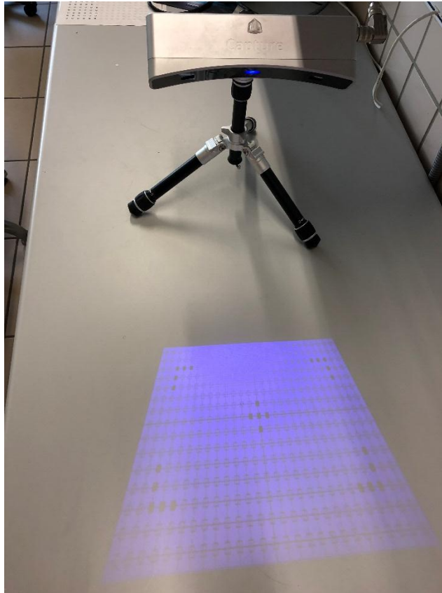
Figura 2.7 Focos de la cámara y centro de patrón proyectado
