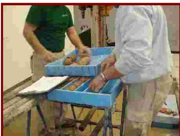
Detalle de cajas con las muestras debidamente colocadas y con indicaciones claras de la profundidad a la que se encontraba cada tramo extraído.
