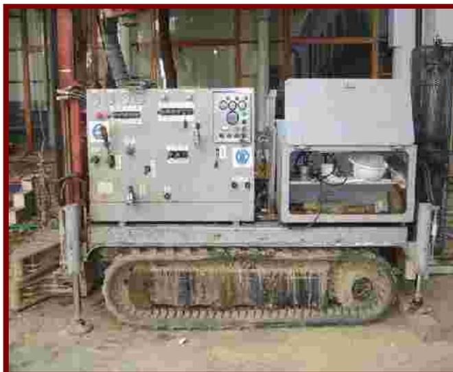
Maquina para sondeos usada en el patio central (a "cielo abierto")
