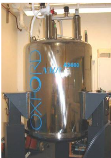
Figura III.10. Instrumento de espectrometría de resonancia magnética Varian INOVA TM
