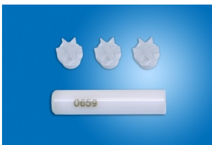
Figura III.13 Imagen de un rotor Bruker ® de zirconio utilizado por el CPMAS RMN y 3 puntas giratorias de policlorotrifluoretileno (PCTFE o Kel-F ® ). Imagen tomada desde https://store.bruker-biospin.com/shop/IT/product/H14355/
