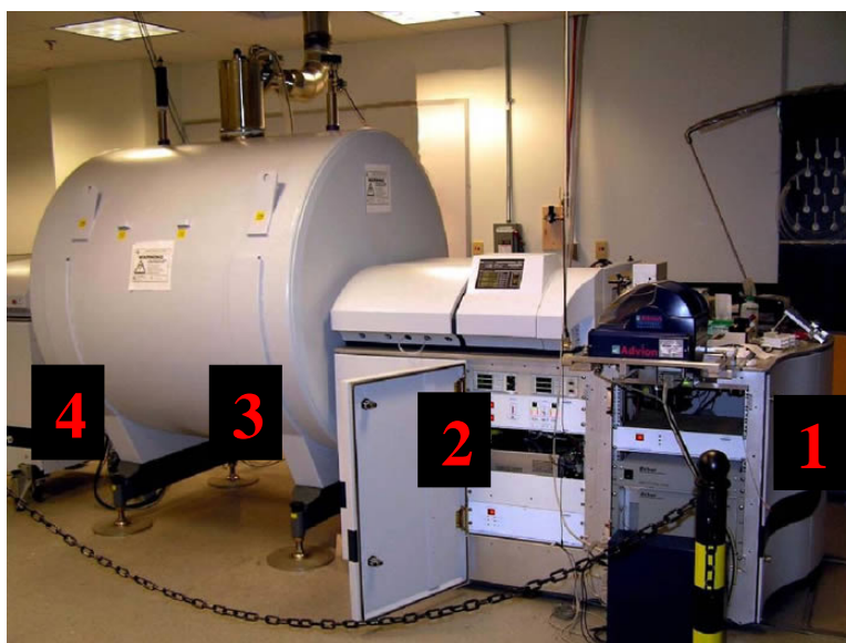
Figura III.14 Imagen del instrumento FT-ICR MS del laboratorio “COSMIC” en Norfolk (VA, EEUU). Se puede apreciar (1) la fuente de ionización por electrospray; (2) la línea de transferencia iónica; (3) el escudo aislante exterior del imán del analizador ciclotrónico; (4) la unidad electrónica donde se almacenan los datos obtenidos.
