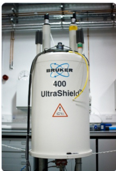
Figura III.12. Instrumento de espectrometría de resonancia magnética Bruker AVANCE II 400 TM
