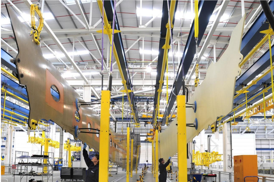
Fig. 52. Instalaciones de Broughton (Gales) en las que se produce la integración del grupo alar del A350XWB
