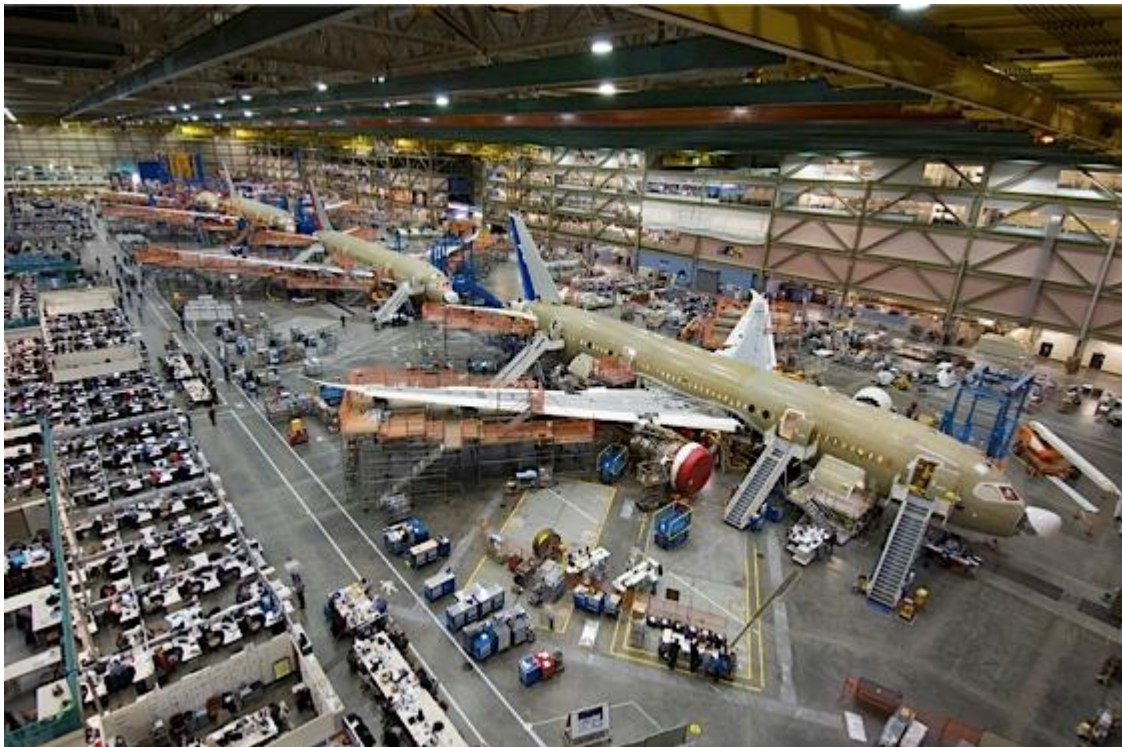
Fig. 51. Ejemplo de FAL. Instalaciones de Everett, Washington, durante el ensamblaje del Boeing B787
