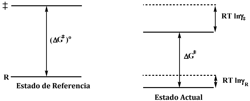
Esquema 1. Representación esquemática de los cambios en la energía libre de activación de una reacción cuando el sistema pasa de un estado de referencia a un estado actual.
